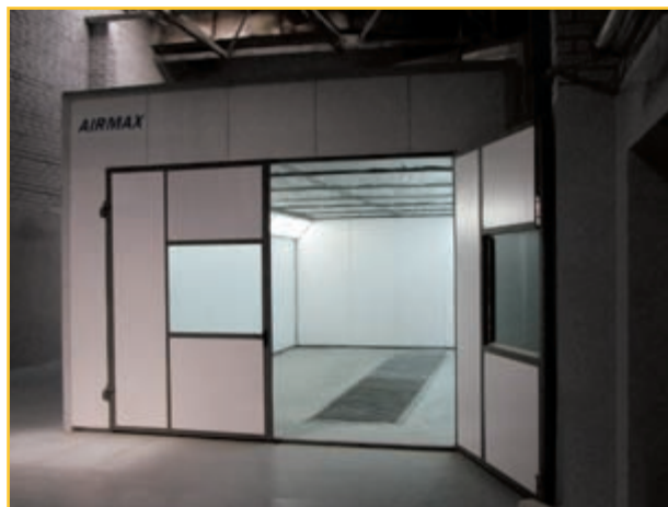
Прочные и герметичные кабины ОСК AIRMAX в стандартном исполнении оснащают угловыми четырехрядными светильниками, создающими бестеневое освещение.
